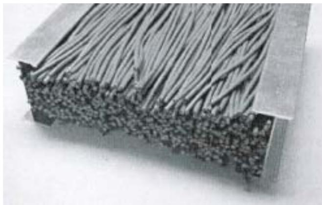
**Photo 1 - Exemple d'un chemin de câbles calculé à un taux de remplissage de 50 % de l'aire transversale.**
